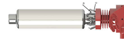
2. 将熔断器撞针方向套入梅花夹①，并用特定工具将卡箍②锁紧
